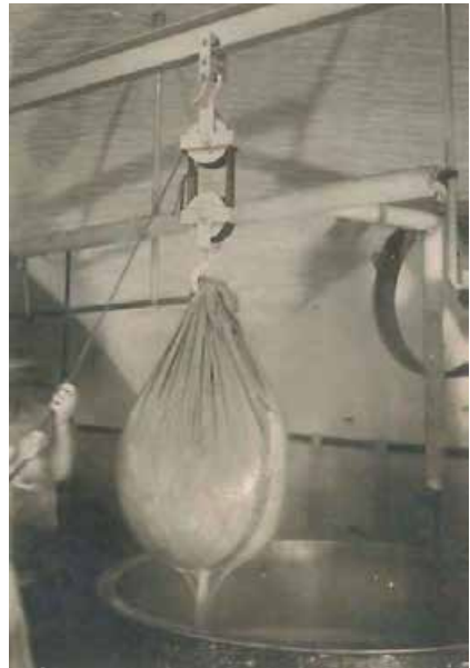
Wyciąganie masy serowej z kotła za pomocą chusty lnianej i wielokrążka.
