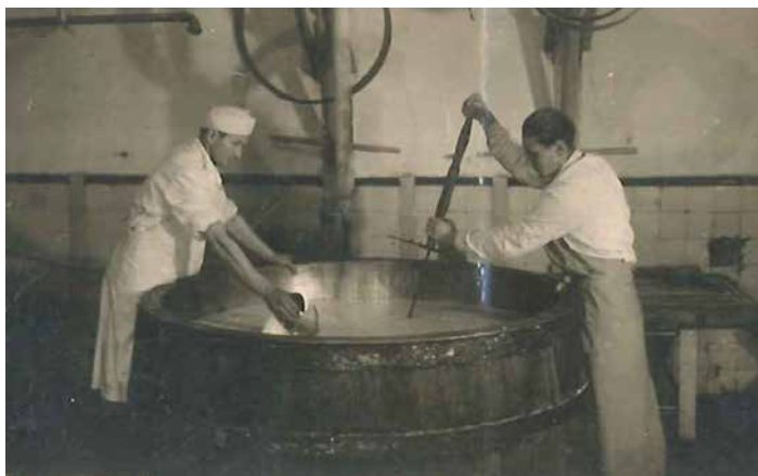
Obróbka masy serowej w kotle za pomocą tzw. „harfy”. Po lewej Bronisław Nosek.
